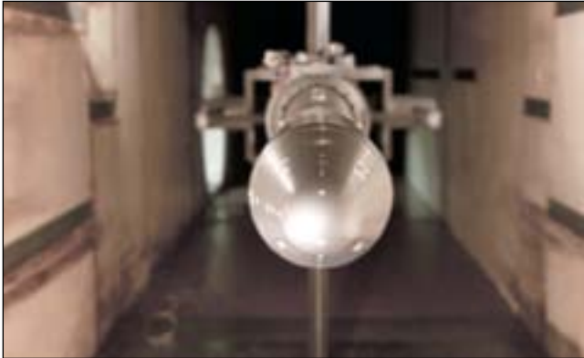
Модель новой головной части «Протон» в аэродинамической трубе Т-109
