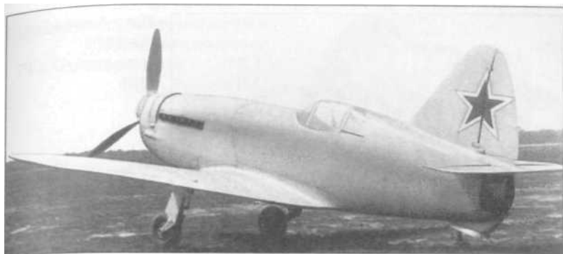
Самолет И-250(«Н») ОКБ-155А.И. Микояна с ВРДК К.В. Холшевникова (вид сзади)
