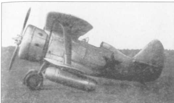
Истребитель И-153 «Чайка» с ПВРД ДМ-4 И.А. Меркулова (вид сбоку) [12]
