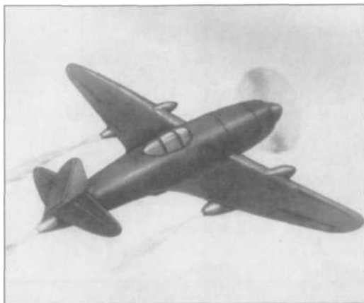
Проект самолета Ла-5ВИ с ЖРД РД 1 В.П. Глушко, предложенный С.П. Королевым
