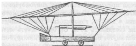
Рис. 1.2. Проект самолета с РД «Аэронава» француза Ш. де Луврие [1]
