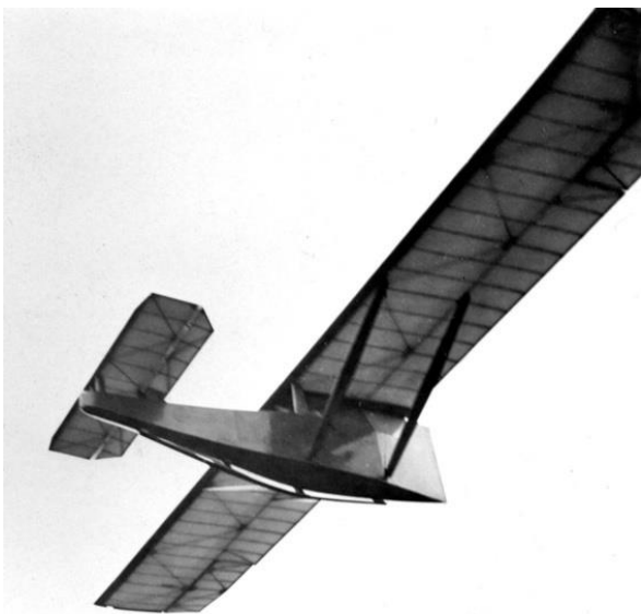
Die drei Flugbilder lassen sehr schön die Entenkonfiguration und die auf den Flügelspitzen angebrachten Pendelruder für die Seitensteuerung erkennen. Rhön, Sommer 1927. (Sammlung DEHLA)
