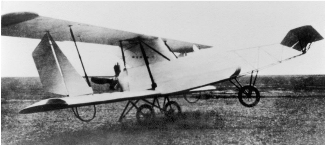
Von der Raab-Katzenstein „Ente“ ist nur eine einzige Fotoaufnahme überliefert, die zudem von mäßiger Qualität ist. Für das Einfliegen hatte man im Heck der Maschine einen Dreizylinder-Anzani-Sternmotor eingebaut. Aufnahmezeitpunkt: Frühjahr 1929. Von dem nachfolgenden Raketenflugversuch existieren keine fotografischen Belege, was bei dem bekannten Publizitätsinteresse von Raab eigentlich erstaunlich ist.
