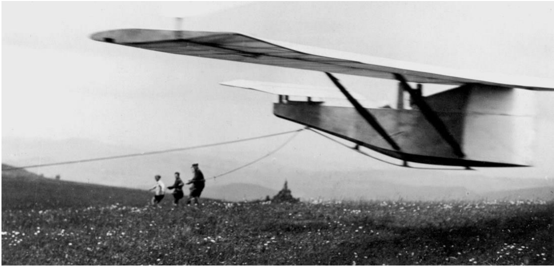
Gummiseilstart der RRG „Ente“ am Westhang der Wasserkuppe, Sommer 1927. (Sammlung DEHLA)
