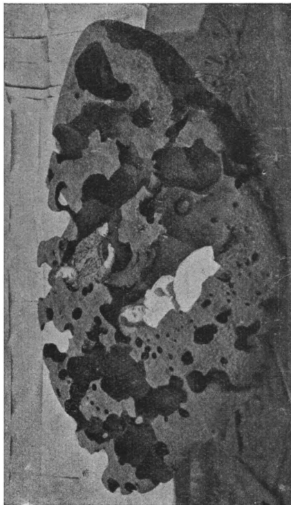
Abb. 25. Meteoreisen von Willamette, Oregon. Gefunden 1903. Die großen Löcher sind durch Auswitterung von Magnetkies entstanden.
