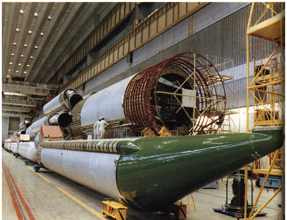
Oben: In dieser Halle des Chrunitschew-Werkes für Maschinenbau erfolgt die Montage des Modul T für die Orbitalstation Mir
