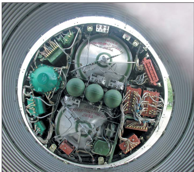
Компоновка приборов в отсеке ракеты Р-36М2 «Воевода»
