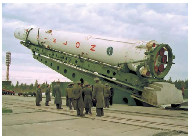
Установка РН «Циклон-3» на пусковом столе
