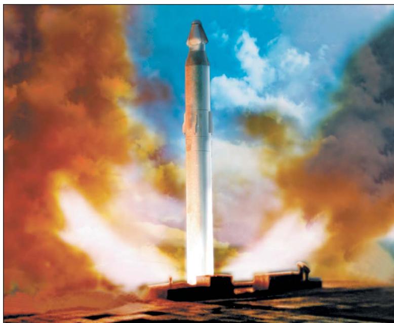
Газодинамический старт из ШПУ МБР Р-36 с РГЧ
