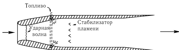
Рис. 69. Принципиальная схема, показывающая элементы прямого воздушно-реактивного двигателя. (Из книги Joseph Liston, Power Plants for Aircraft [copyright 1953, McGraw-Hill Book Co., Inc.], с разрешения.)
