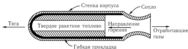
Рис. 71. Принципиальная схема, показывающая элементы ракетного двигателя твердого топлива. (Из книги М. J. Zucrow, Jet Propulsion and Gas Turbines [copyright 1948, John Wiley and Sons, Inc.], с разрешения.)
