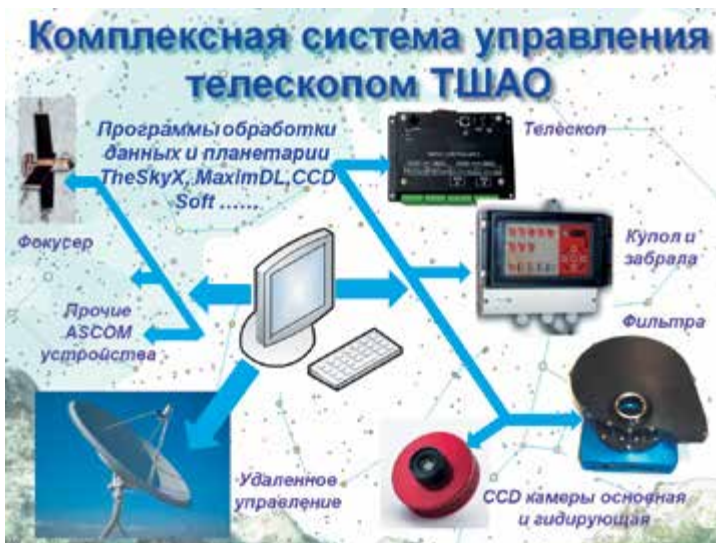
Рисунок 2 — Архитектурасистемы управления метровыми телескопами
