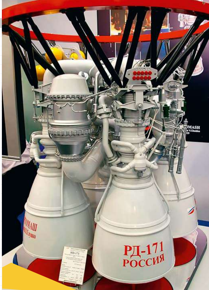
▲ На «Фениксе» хотят применить жидкостные ракетные двигатели RD-171 Фото: Edoe. www.ru.wikipedia.org
