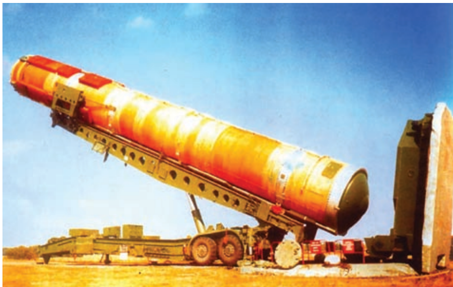
Загрузка ракеты Р-36М2 в шахтно-пусковую установку
