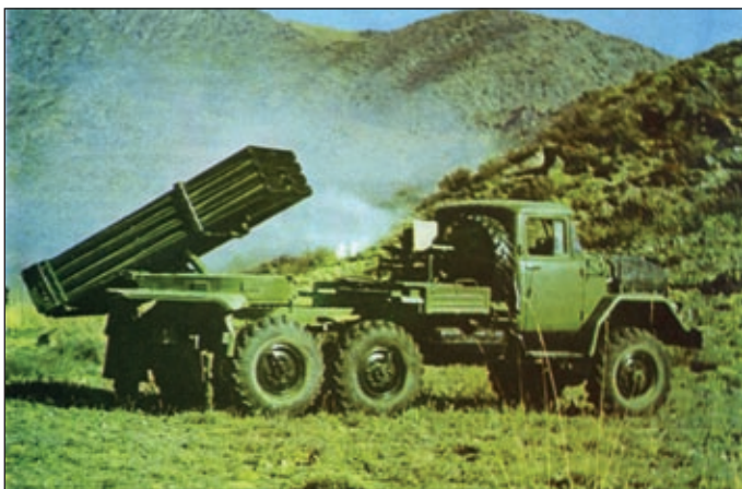
«Град-1» ведет огонь. Хорошо видно развернутое основание пусковой установки (с крыльями задних колес) и вытисненные механические упоры в задней части машины
