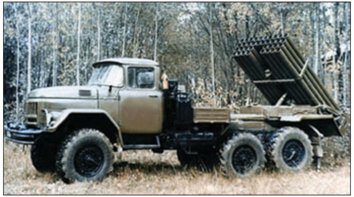
РСЗО «Град-1» на шасси автомобиля ЗиЛ-131 в боевом положении. Хорошо видно, что в пакете только 36 направляющих (в двух нижних рядах отсутствует по паре стволов).
