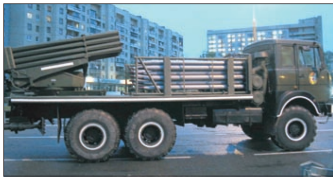
Белорусская система залпового огня «БелГрад» на шасси автомобиля повышенной проходимости МАЗ-6317. За счет большей длины шасси автомобиля МАЗ-6317 между пусковой установкой и кабиной удалось разместить стеллаж для 40 реактивных снарядов.
