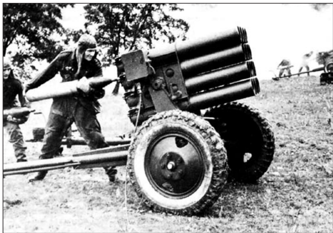
Буксируемая 16-ствольная пусковая установка РПУ-14, которой в 50-х годах состояла на вооружении воздушно-десантных войск
