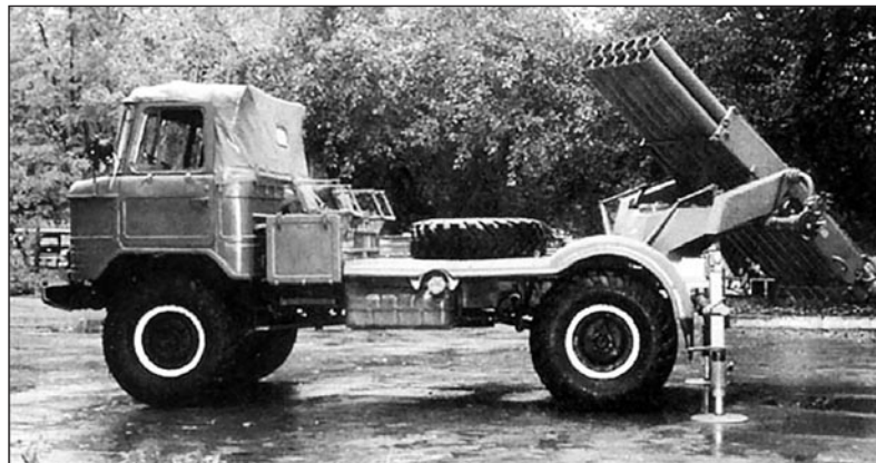
Авиадесантируемая боевая машина БМ-21В на шасси автомобиля ГАЗ-66. По сравнению с БМ-21 количество направляющих уменьшено до 12 штук (пусковая установка находится в боевом положении)
