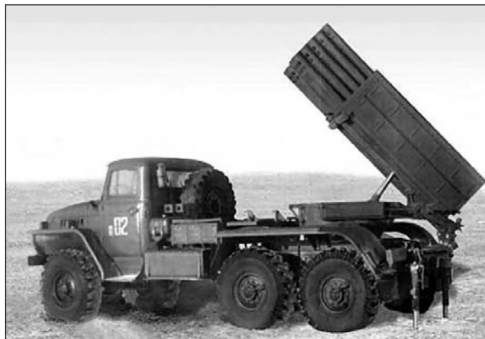
Боевая машина РСЗО 9К53 «Прима». Хорошо виден пакет из 50 направляющих, расположенных в пять рядов (в двух нижних рядах средние стволы отсутствуют, что сделано для размещения подъемного гидроцилиндра)
