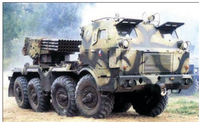
Система залпового огня RM-70 разработки ЧССР. RM-70 представляет собой комбинацию артиллерийской части советской БМ-21 с шасси чехословацкого автомобиля повышенной проходимости Татра-813. Артиллерийская часть установлена в задней части машины, а между ней и кабиной размещена механизированная боеукладка (стеллаж) на 40 реактивных снарядов
