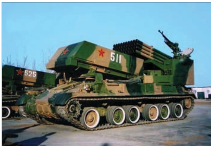
Китайская РСЗО — Тип 83, созданная на основе советской системы БМ-21. Пусковая установка размещена на гусеничном шасси (перед пусковой — механизированное устройство перезарядки)
