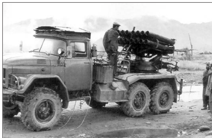
Захваченная моджахедами в Самархеле в 1989 году РСЗО БМ-21-16. Это очень редкий вариант — на шасси ЗиЛ-131
