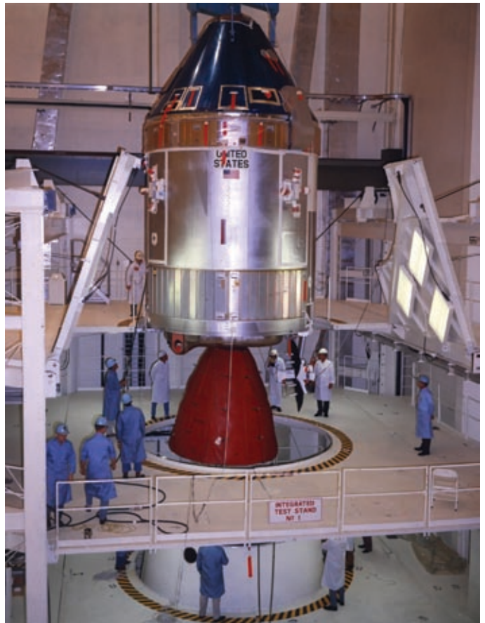
Монтаж командного модуля (CSM-107) корабля Apollo 11
