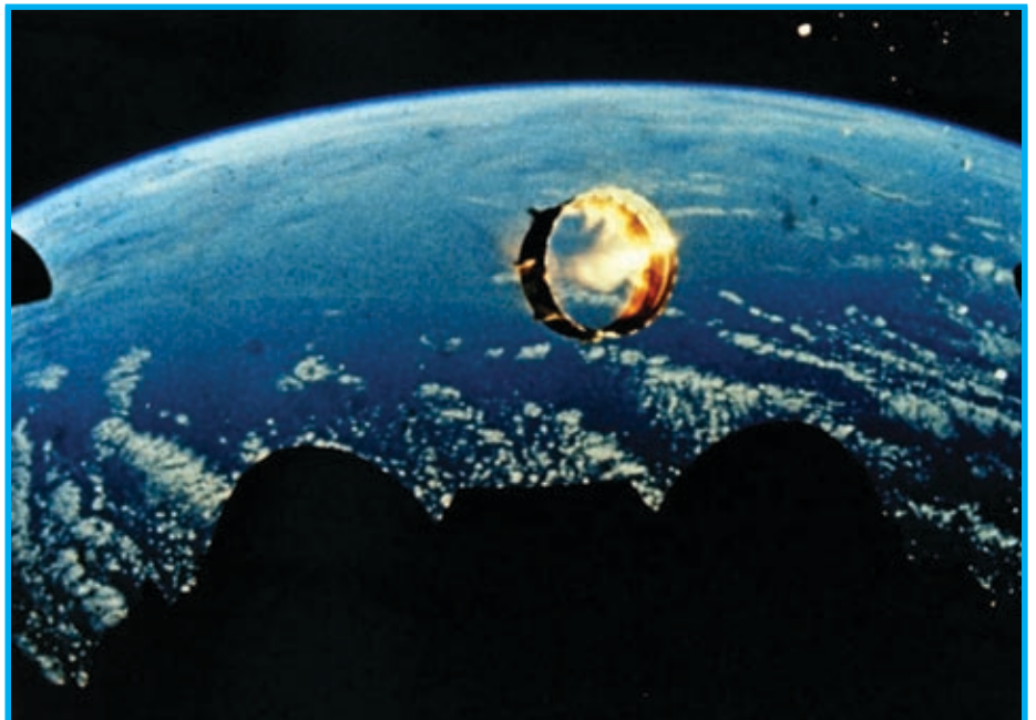
Переходник между блоками первой и второй ступени отбрасывается после выхода двигателя второй ступени на режим
