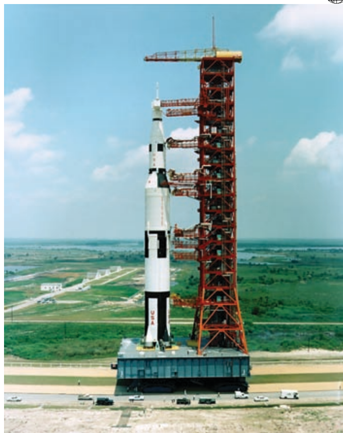
Мобильная пусковая установка SA-500F с РН Сатурн-V направляется к месту старта
