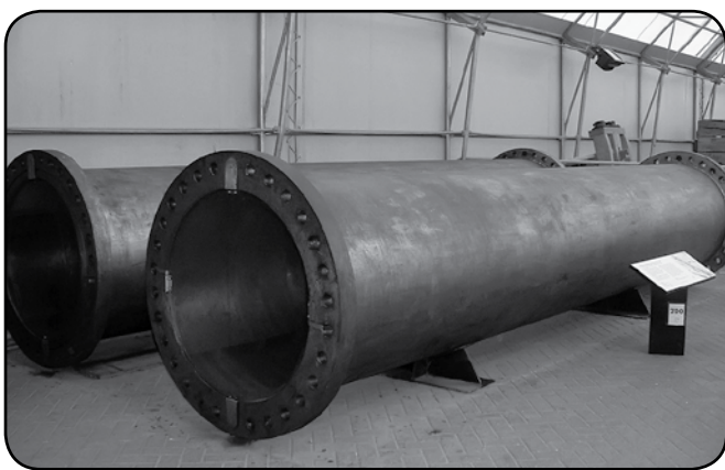
Две секции «Большого Вавилона», диаметр ствола 1000 мм, в настоящее время экспонируются в форте Нельсон, Портсмут, США
