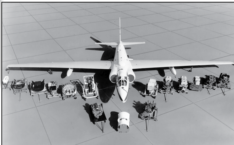
U-2С с вариантами исследовательского и разведывательного оборудования, которое могло устанавливаться на борту самолета
