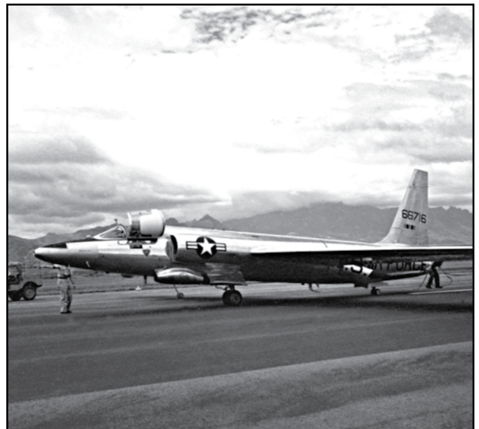
WU-2A начинает руление на стоянку после посадки. Под крыльями закреплены пружинные стойки
