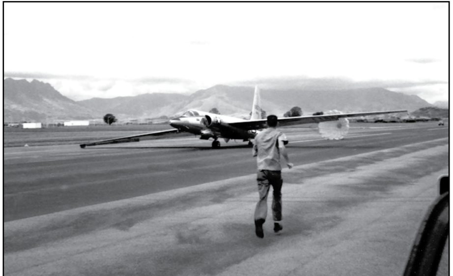
Посадка самолета WU-2A. На левом борту виден воздухозаборник системы взятия проб воздуха на радиоактивность
