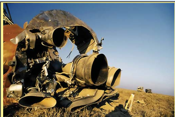
Рис. 3. Остатки первой ступени ракеты-носителя «Союз» после падения на поверхность Земли (Фото: J. Bendiksen)
