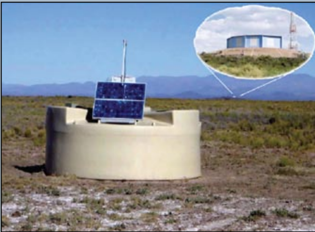
Черенковский детектор обсерватории «Пьер Оже». На холме расположен телескоп типа «глаз мухи»
