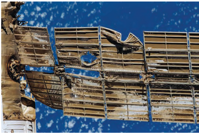
Солнечная батарея станции «Мир» получила значительные повреждения от космического мусора
