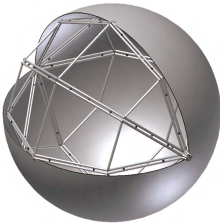
Рис. 2. Каркасная конструкция шарообразной оболочки
