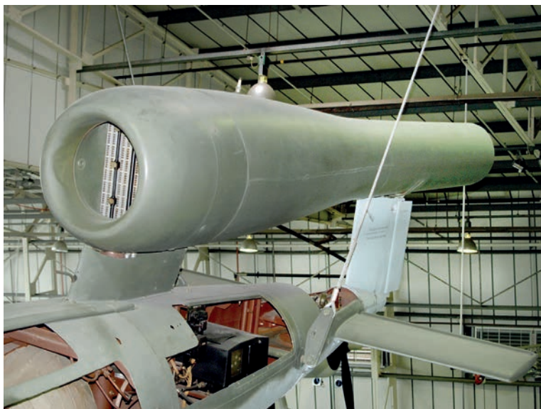
Пульсирующий реактивный двигатель (ПуРД) на крылатой ракете Фау-1
