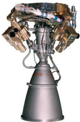
Блок маршевого двигателя четвертой ступени европейской РН «Вега»
