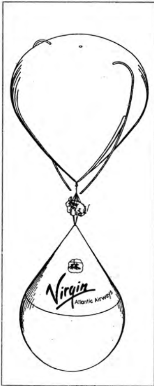
Рис. 1. Общий вид воздушного шара: вверху - шар с гелием, посредине - кабина экипажа шара, внизу - балластный шар с воздухом.
