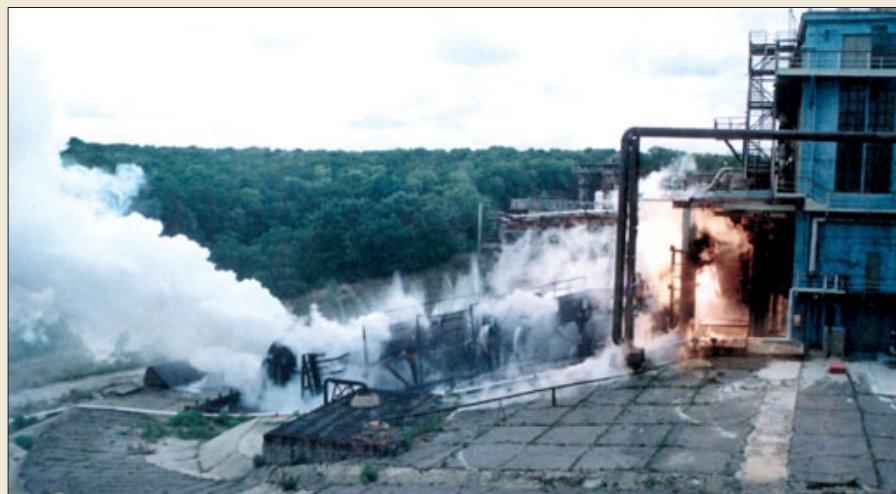
Огневое испытание двигателя на наклонном стенде
