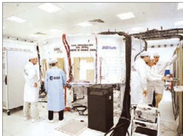
Идут испытания на электрическом аналоге приборно-агрегатного отсека ATV
