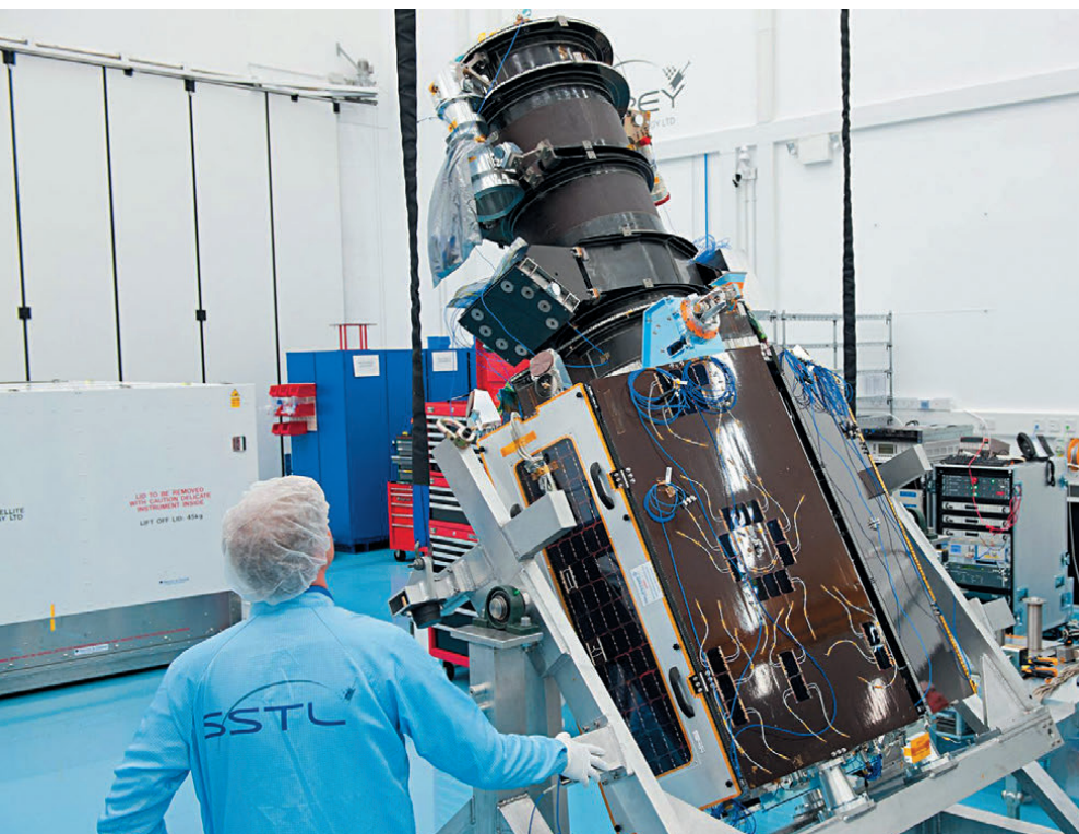
▲ Сборка телескопа VHRI-100 спутника на базе платформы SSSL-300S1
