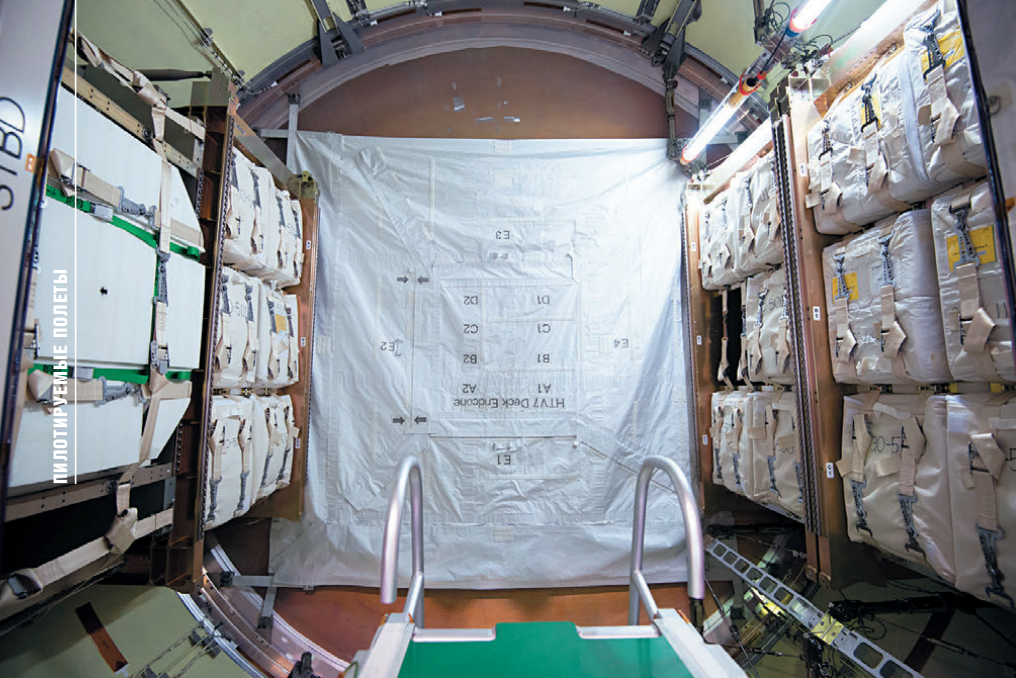
▲ Герметичная часть грузового корабля HTV-7 заполнена стандартными сумками СТВ
