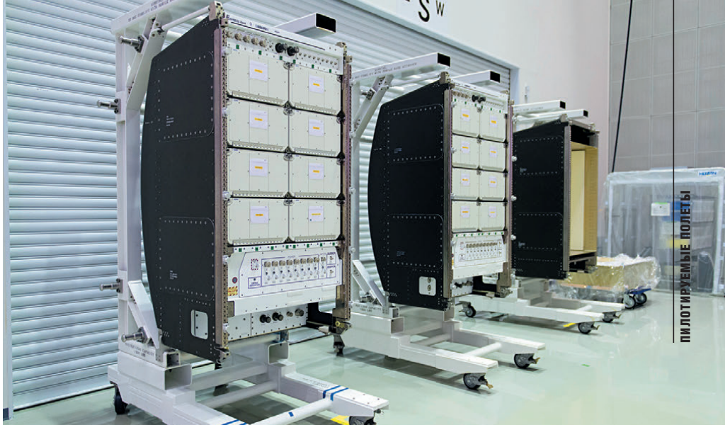
▲ Стойки Express Rack 9B, Express Rack 10B и транспортировочный бокс для LSG
