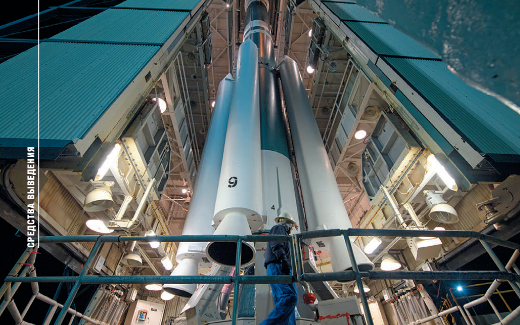
▲ Ускорители GEM на первой ступени ракеты-носителя Delta II
