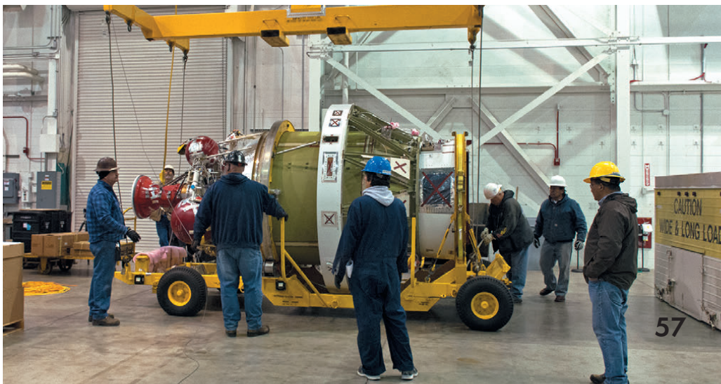
▼ Вторая ступень ракеты-носителя Delta II – сопло двигателя второй ступени еще не установлено
