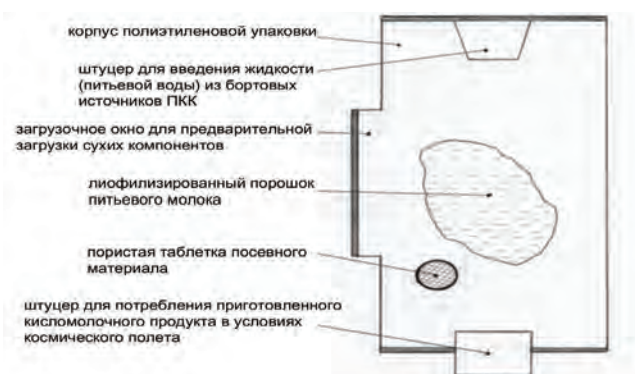
Рис. 3. Спецпакет «Продукт», используемый в качестве биореактора для получения кисломолочного пробиотического продукта в условиях космического полета [3]
