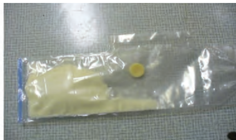
б) Внешний вид снаряженного сухими компонентами пакета перед отправкой его на борт МКС
