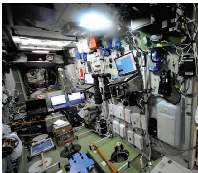
Рис. 6. Рабочее место космонавта при осуществлении функций управления РТС с борта МКС – космический эксперимент «Контур-2»
