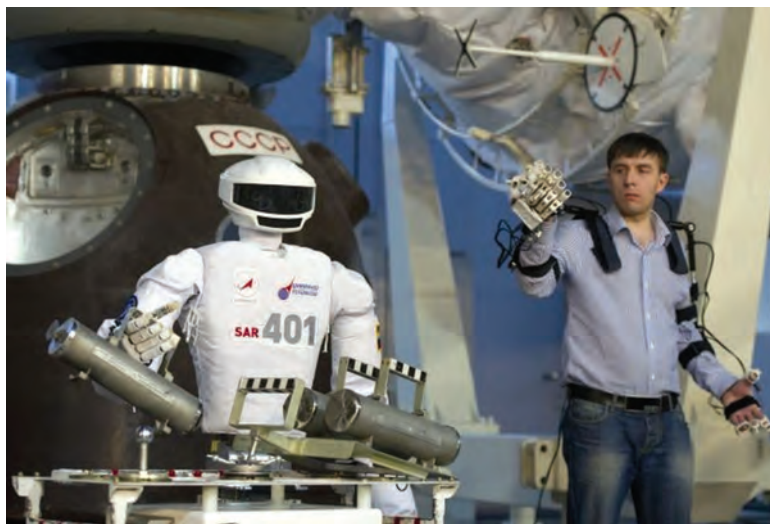
Рис. 4. Испытание АРТС в копирующем режиме управления по замене блоков научной аппаратуры
