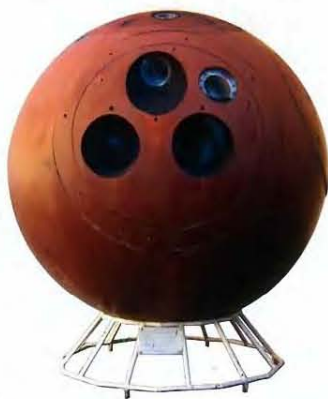
ШАР СПУТНИКА “ЗЕНИТ” по форме идентичен спускаемому аппарату корабля “Восток” (слева)
