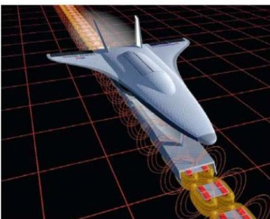
Атракцион разгоняет пассажирскую капсулу до 100 км/ч за 2,8 с. Система EMALS стреляет втрое быстрее многотонными боевыми самолетами. Именно EMALS в настоящее время служит главным источником данных для программы EHLV. На базе ВМФ США в Лейкхерсте военные уже третий год проводят ее тестирование. В 2010 году было проведено более 700 пробных беспилотных запусков, а в конце декабря электромагнитная катапульта успешно запустила в небо пилотируемый истребитель-бомбардировщик F/A-18E Super Hornet.
