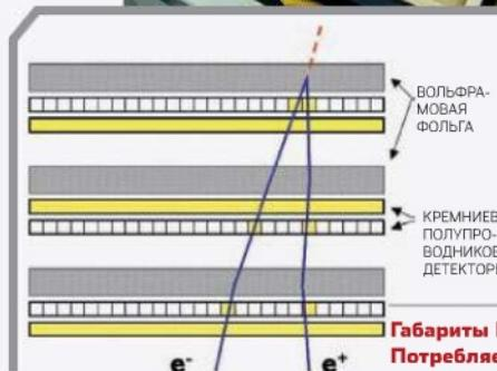
**LAT СОСТОИТ** из 16 наборов полупроводниковых детекторов и калориметров из йодида цезия, которые закрыты 89 полимерными детекторами антисовпадений. Система обработки считывает сигналы детектора антисовпадений, полупроводниковых детекторов и калориметра и определяет направление и энергию гамма-квантов.
