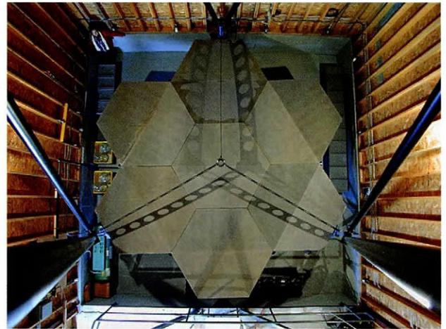
ЗЕРКАЛО ТЕЛЕСКОПА LZT представляет собой пластиковую чашу из семи шестиугольных и шести треугольных сегментов. Сегментам с помощью термоформовки придается форма параболоида вращения, чтобы минимизировать толщину слоя ртути готового зеркала.
