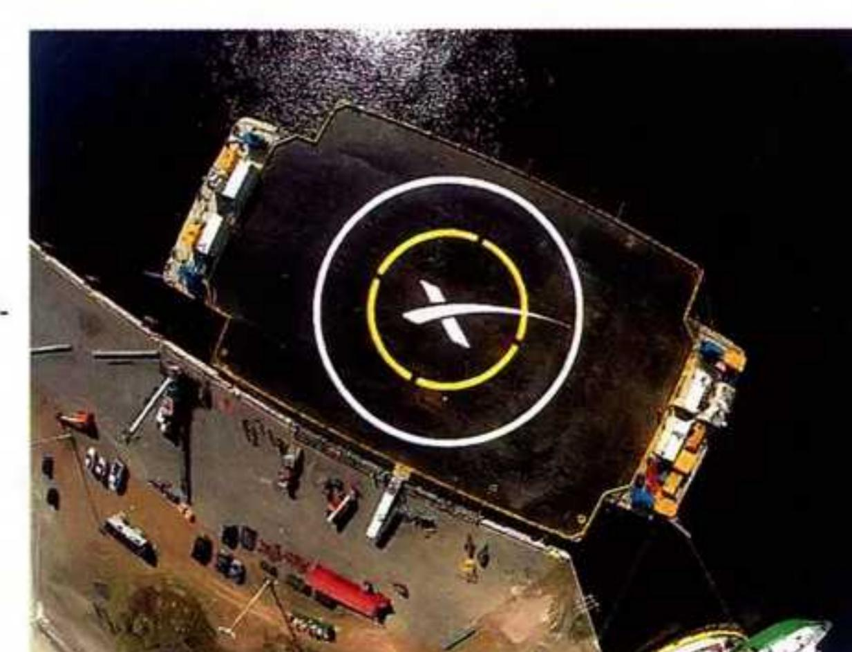
Автономный роботизированный плавучий космодром ASDS, переоборудованный из баржи Magmas 300, оснащен четырьмя азимутальными подруливающими устройствами и системой GPS и способен сохранять заданную позицию с точностью до 3 м даже в штормовых условиях.
