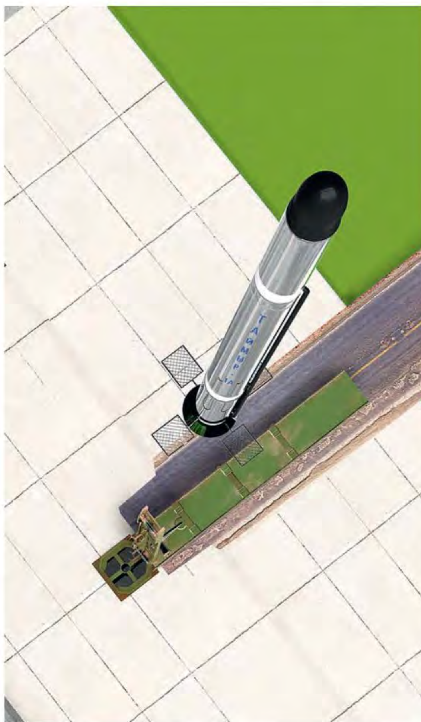
Стандартные модули «Таймыр»: универсальный ракетный блок первой ступени (УРБ-1), универсальный ракетный блок третьей ступени (УРБ-2), ракетные блоки второй и третьей ступеней (РБ-1 и РБ-2).
