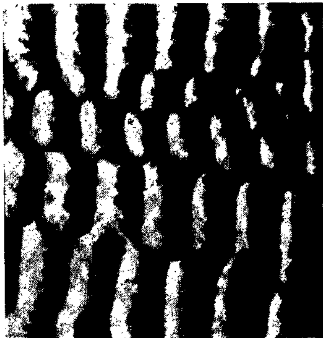
Рис. 4.14. Рябь на поверхности горения баллистического топлива JPN после прерванного вибрационного горения. Рябь ориентирована в тангенциальном направлении
