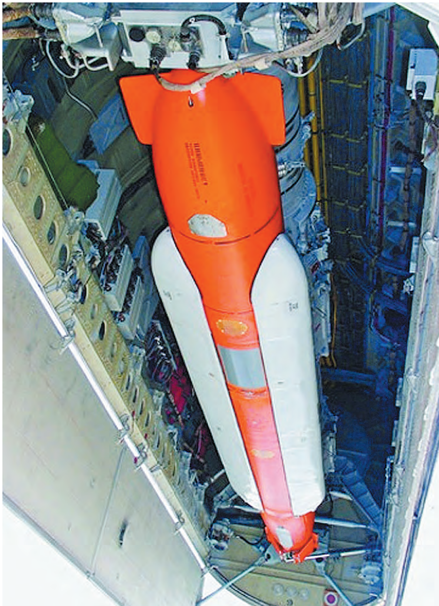
Крылатая ракета X-555 со спутниковой системой наведения на многозарядном пусковом устройстве MKU6-5
