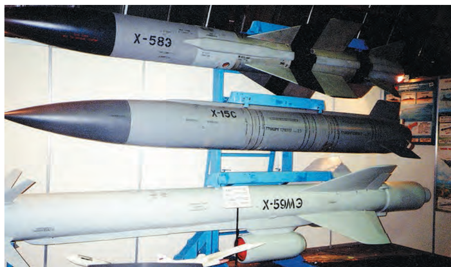
Противокорабельная ракета X-15C (в центре) с проникающей БЧ. Фото С.Г. Мороза
