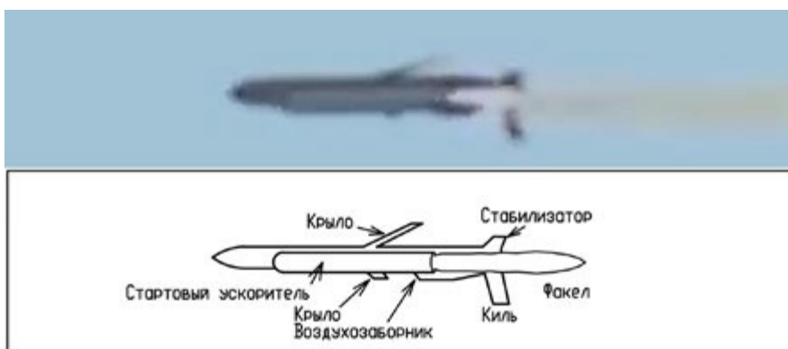
Буревестник в полёте. Можно различить стреловидное крыло большого удлинения, значительный по размерам стартовый ускоритель и факел от его работы. Довольно большой киль расположен снизу
