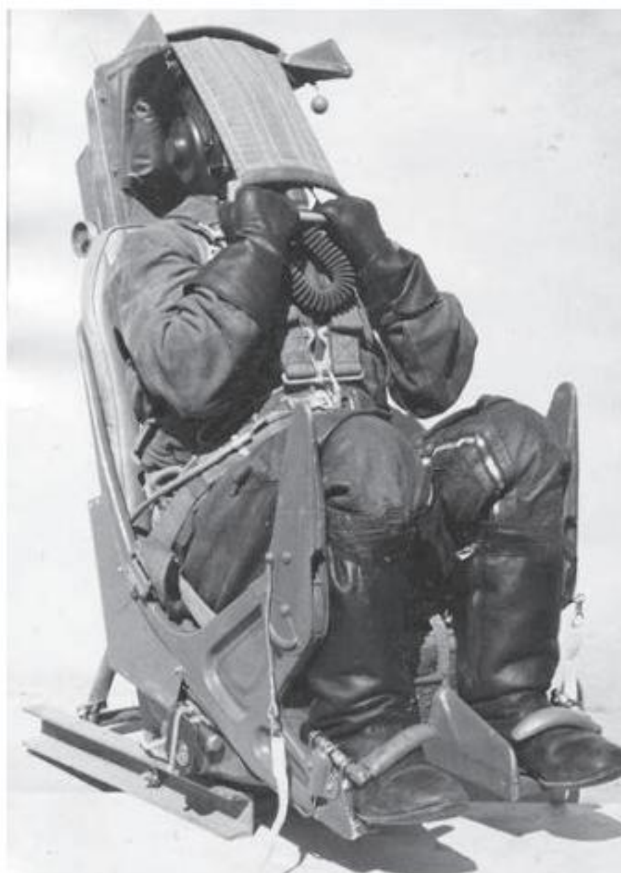
Кресло К-8 с испытателем в позе, исходной для катапультирования
