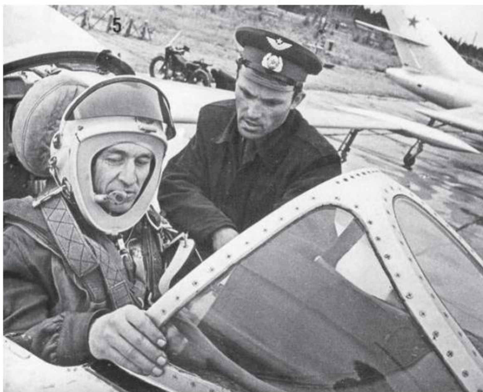
Лётчик в высотном-компенсирующем костюме ВКК-3 с гермошлемом ГШ-4 в кабине Як-25РВ
