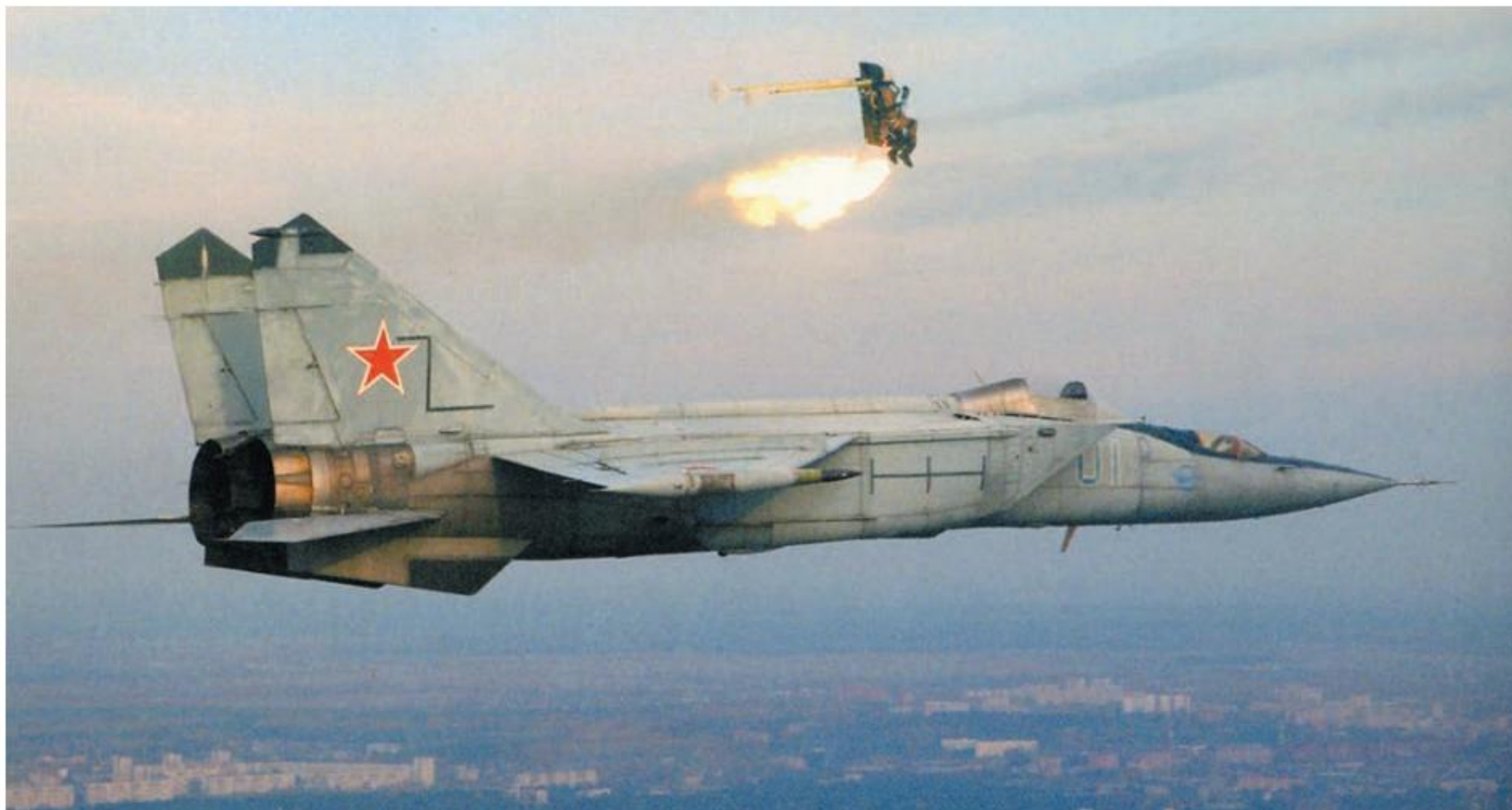
Катапультирование кресла К-36Д-3,5 из летающей лаборатории МиГ-25
