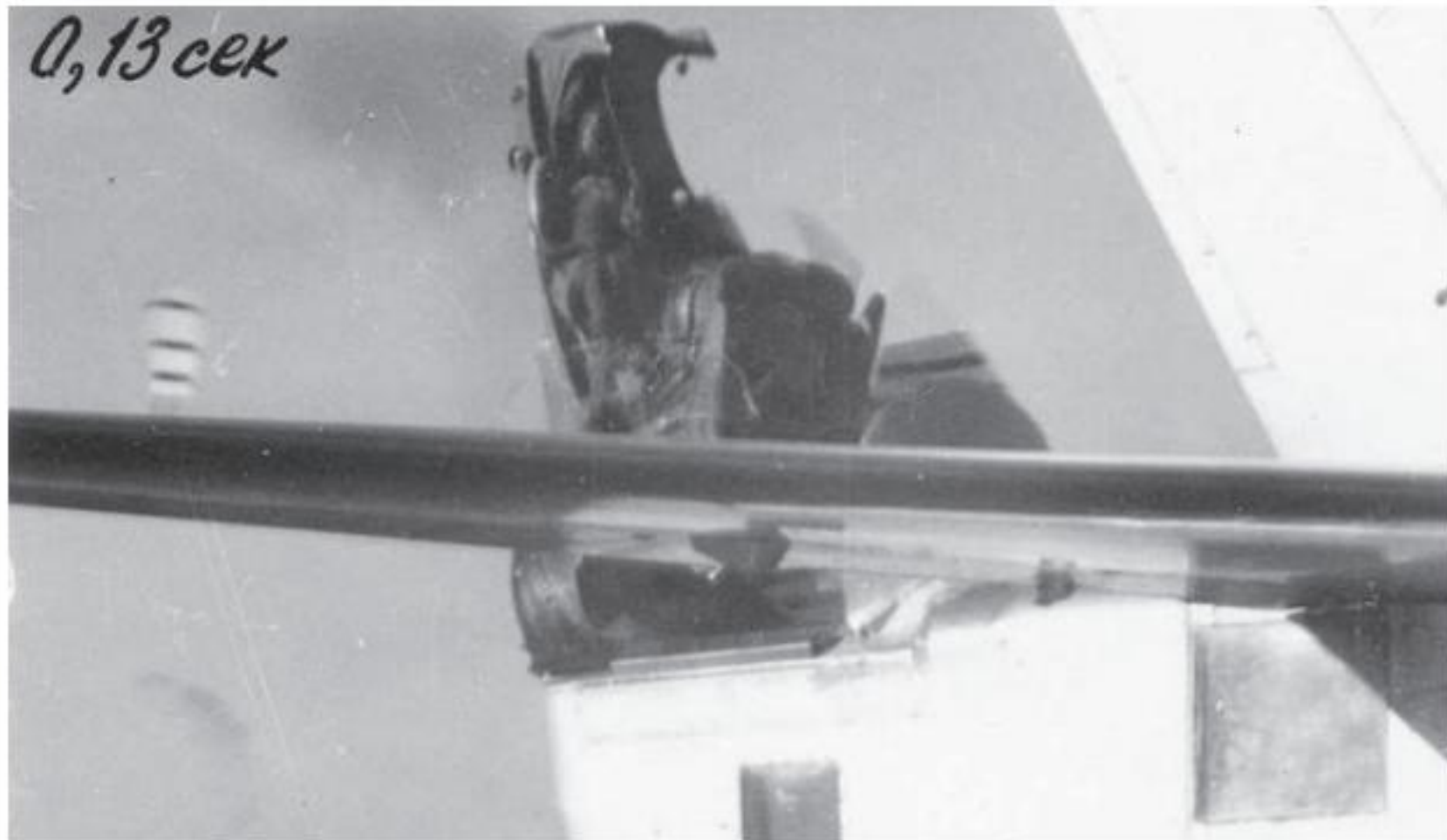
Испытание кресла К-8 без манекена на летающей лаборатории Ил-28
