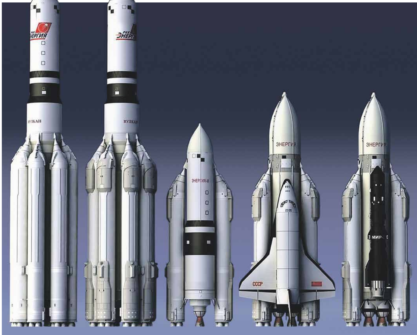
Семья «Энергии»: «Вулкан» с одноразовыми и спасаемыми блоками 1-й ступени, «Энергия-М», «Буран», «Энергия-Т»
