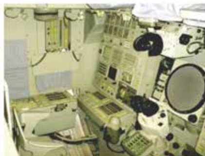
Пульты комплекса отображения информации «Марс» центрального поста управления ОПС «Алмаз»
