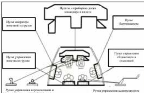
Состав комплекса отображения информации «Вега» ВКС «Буран»
