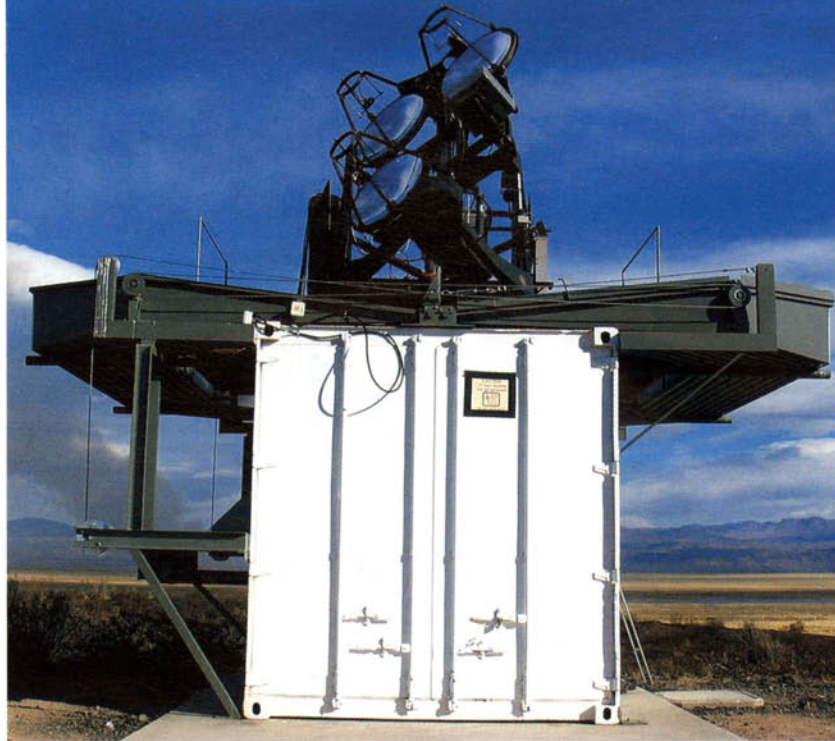
Лидар — лазерная система зондирования атмосферы. Используется при калибровке оптических телескопов обсерватории Оже для искусственного возбуждения молекул атмосферы
