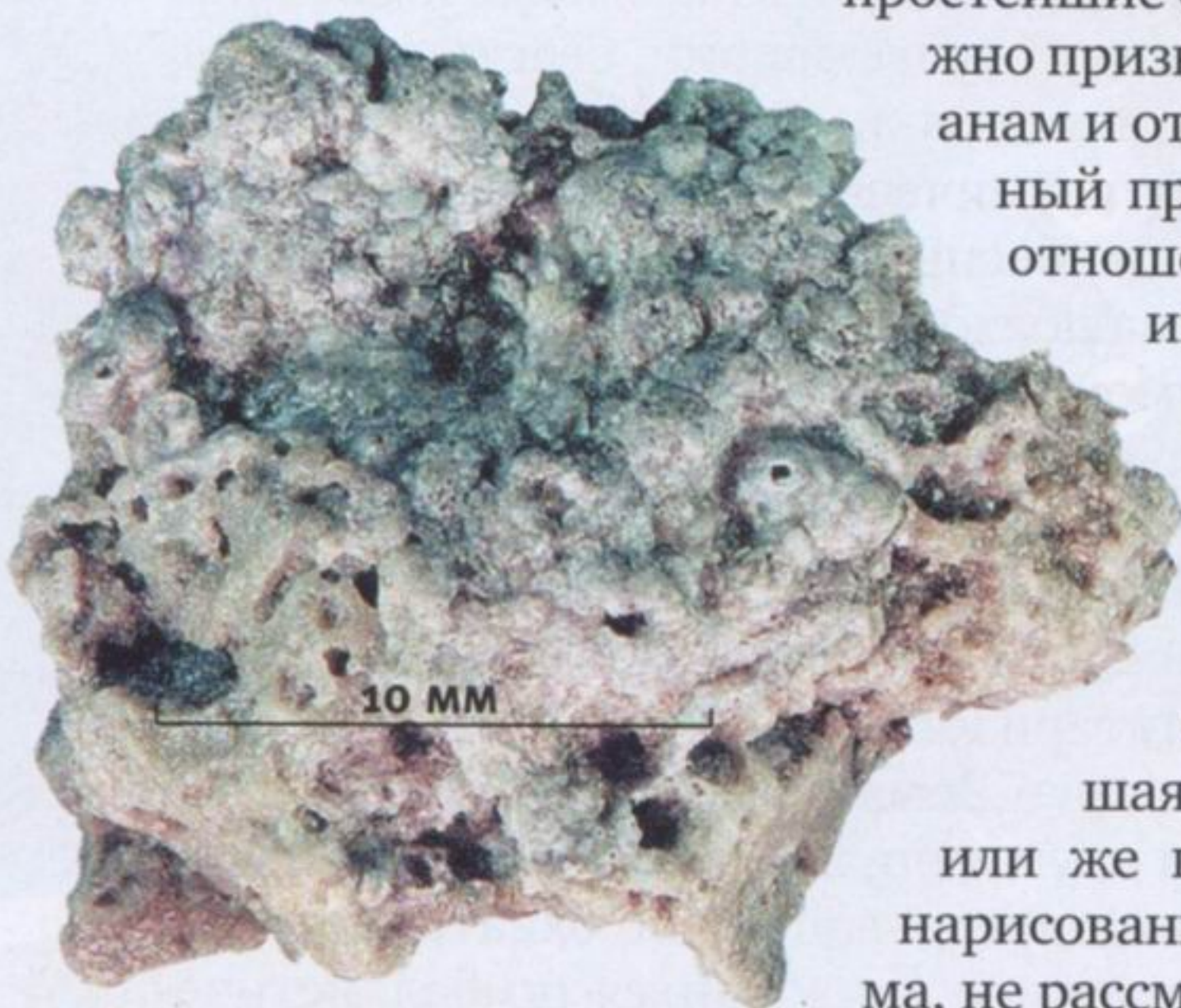
Куски шлака от работы твердотопливных двигателей спутников — основной источник мусора сантиметрового размера
