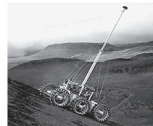
Шестиколесное шасси с грузом на мачте во время испытаний на камчатском полигоне
