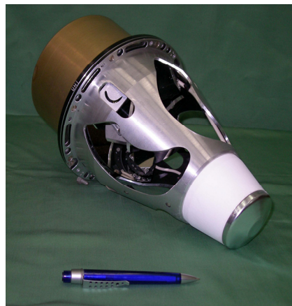
Рис. 1.24. Датчики вертикали Земли секущего типа: а – с восемью засечками; б – с четырьмя засечками
