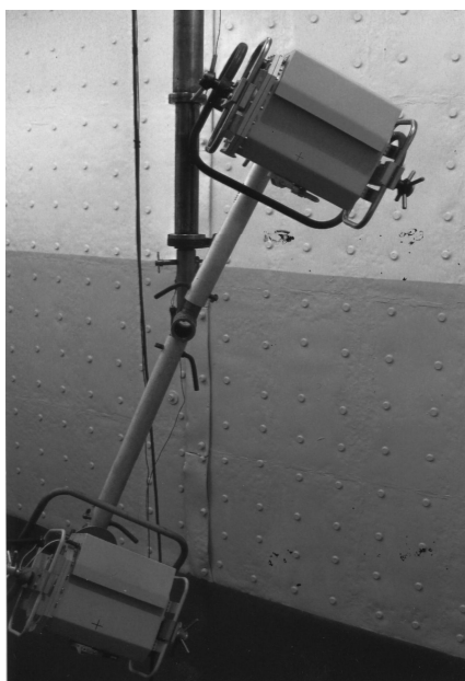
Рисунок 2. Коромысло с двумя аппаратами РАП 160-5
