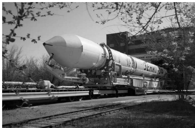
Рисунок 5. Операция «сухой» вывоз ракеты-носителя с РБ «Фрегат-СБ»
