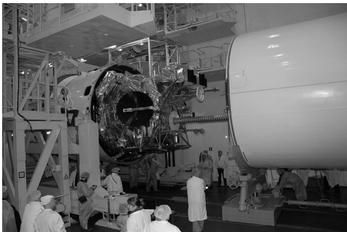
Рисунок 9. Накатка головного обтекателя на КА «Электро». Космодром Байконур.
