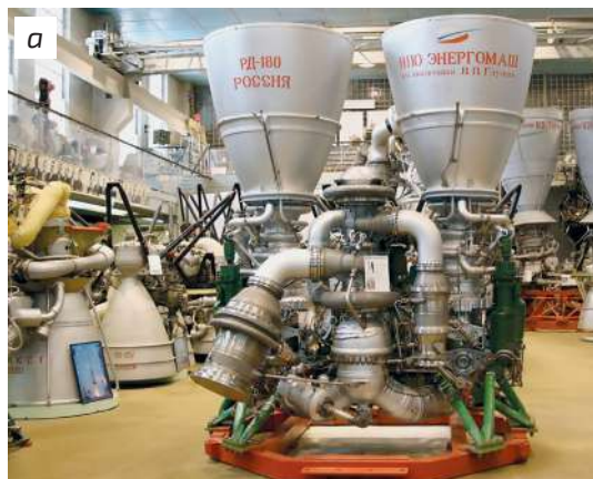
Жидкостный ракетный двигатель РД-180: а – полноразмерный макет ЖРД РД-180 в демонстрационном зале «НПО Энергомаш», б – общий вид
