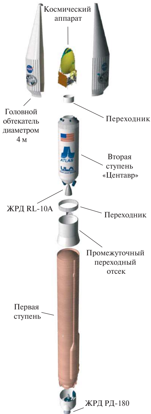
Схема ракеты-носителя «Атлас-5» конфигурации 401. Рисунок NASA
