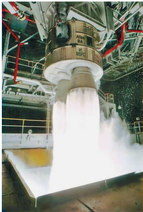
Огневые испытания ЖРД РД-180 в составе первой ступени РН «Атлас» в США. 1997 г. Фото «Пратт энд Уитни», NASA
