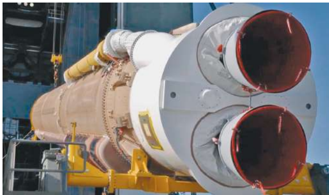
Российский двигатель РД-180 на первой ступени РН «Атлас-5». Космодром на Мысе Канаверал. Фото NASA
