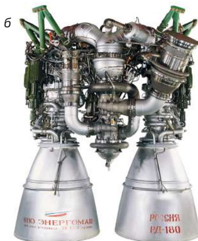
Жидкостный ракетный двигатель РД-180: а – полноразмерный макет ЖРД РД-180 в демонстрационном зале «НПО Энергомаш», б – общий вид
