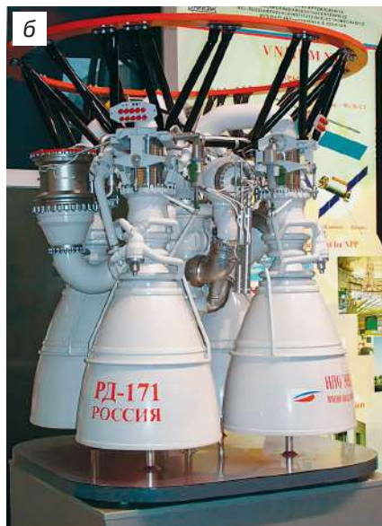
Жидкостные ракетные двигатели семейства RD-170/171: а – полноразмерный макет ЖРД RD-170 в павильоне «Космос» на ВДНХ, б – выставочный масштабный макет ЖРД RD-171
