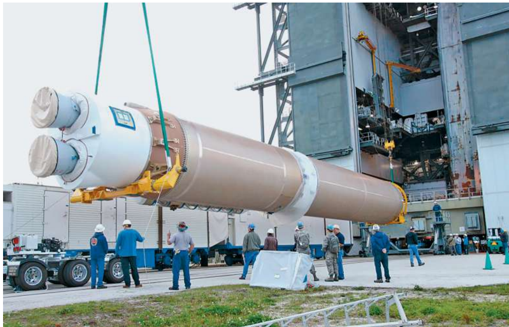
Выгрузка первой ступени РН «Атлас-5» для ее установки в здание вертикальной сборки на космодроме на Мысе Канаверал. 17 февраля 2015 г. Фото NASA
