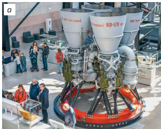
Жидкостные ракетные двигатели семейства RD-170/171: а – полноразмерный макет ЖРД RD-170 в павильоне «Космос» на ВДНХ, б – выставочный масштабный макет ЖРД RD-171
