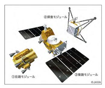
Состав комплекса. 1 – перелетный модуль, 2 – исследовательский модуль, 3 – возвратный модуль. Изображение Mitsubishi Electric
